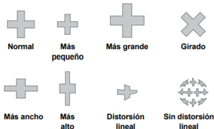
Figura 3 La distorsión de pose o presentación de la pieza [8]
