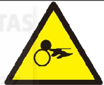
RIESGO DE ATRAPAMIENTO
