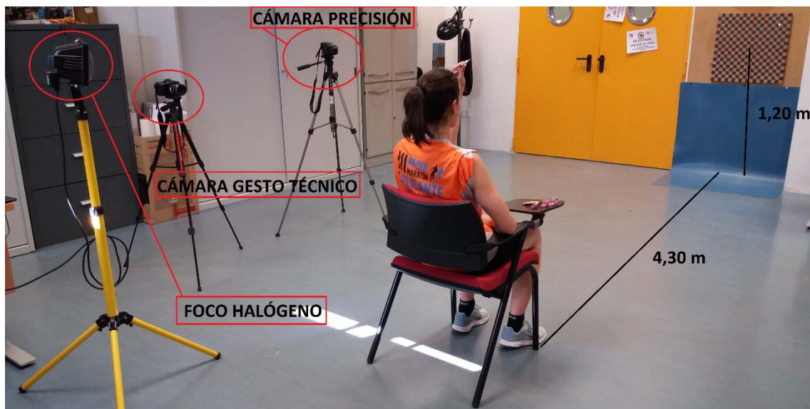
Figura 6. Distancia de lanzamiento respecto a la diana, altura de la diana (centro) y demás instrumental utilizado en cada uno de los test.
