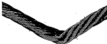
Cliché 20 - Ejemplo de codo muy marcado. El cable debe ser retirado.
