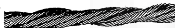
Cliché 17 - Disminución local del diámetro del cable, teniendo tendencia los cordones exteriores a cruzarse en lugar del alma. Observar la presencia de alambres rotos. El cable debe ser retirado inmediatamente.
