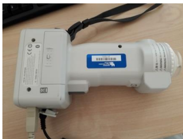
Figura 24. Colorímetro Minolta CM-2600d.
