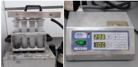
Figura 18. Digestor BüchiDigestionUnit modelo 426.
