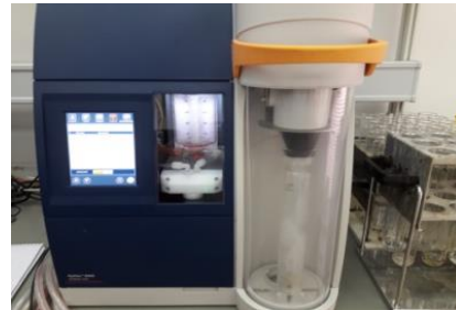
Figura 19. Destilador BüchiDestillationUnit modelo B-316.
