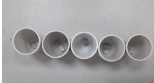
Figura 21. Resultado de las muestras tras someterse a 550 °C en la mufla.
