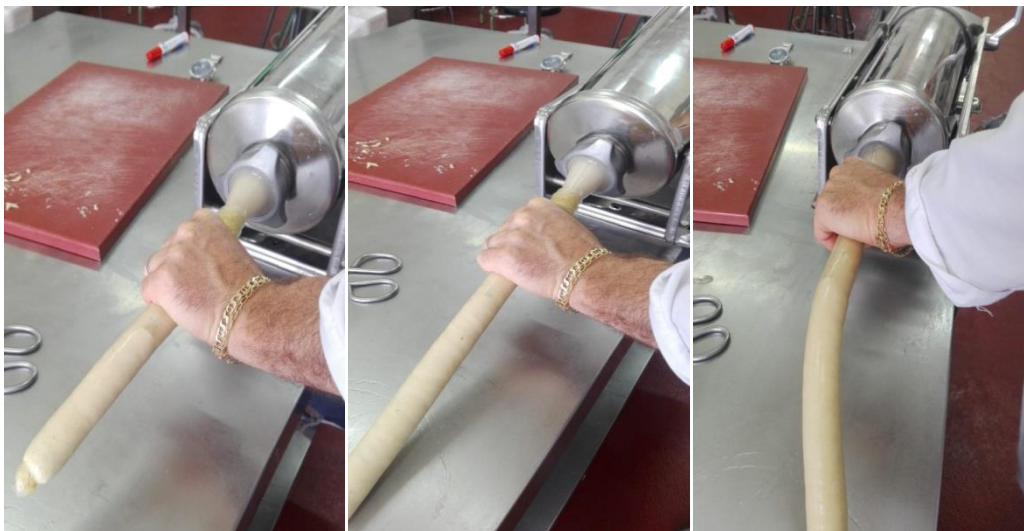
Figura 37. Proceso de embutido de la masa en tripa sintética.
