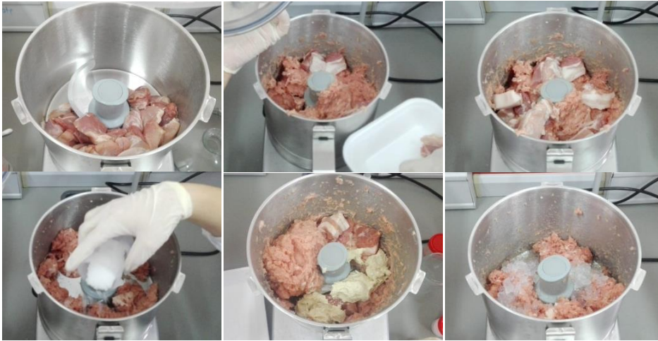
Figura 34. Picado del magro, panceta, adición de la sal, el carrier y el hielo.
