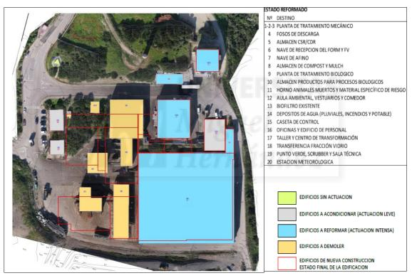
Figura 7. Modificaciones y ampliaciones de las instalaciones propuestas
