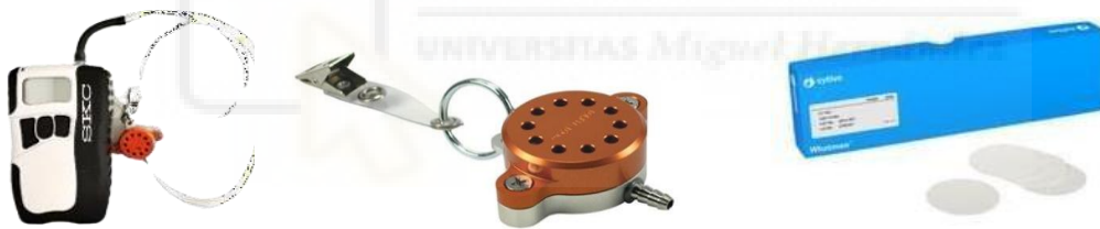
Figura 4. A) Captador de aire “Personal Impactors Model 200”. B) Cabezal PM10. C) Filtros de cuarzo. Imagen de la web de Fisher Scientific [40].
