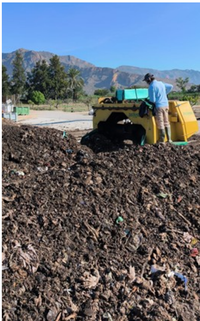
Figura 9. Operación de volteo mecánico de las pilas mediante pala cargadora para la renovación del oxígeno y la prevención de microambientes anóxicos en la masa biológica. Fuente: Elaboración propia (2026)
