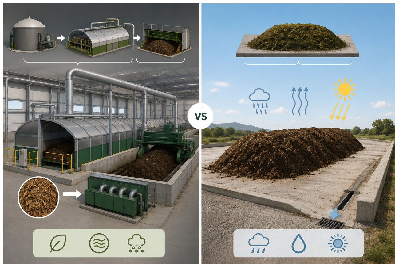
Figura 4. Esquema comparativo entre un sistema industrial cerrado de tratamiento mecánico biológico con reactores de biometanización y un sistema descentralizado de compostaje aeróbico abierto a la intemperie. Fuente: Elaboración propia (2026).
