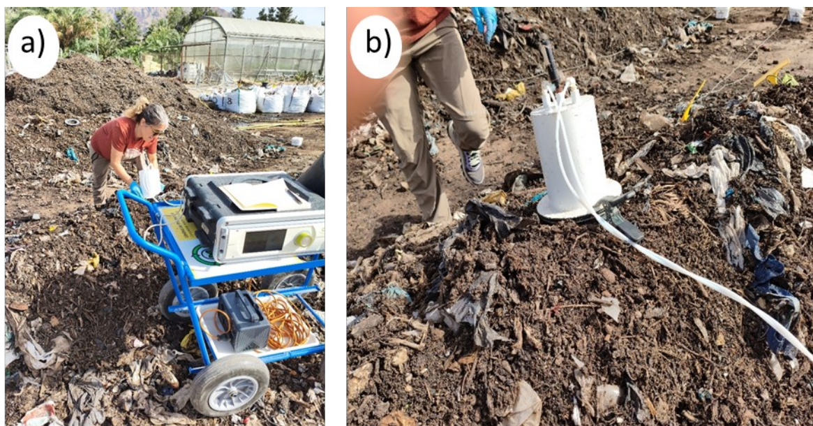
Figura 11. Metodología de monitorización atmosférica en campo: (a) cuantificación analítica y lectura continua de concentraciones in situ mediante el analizador de gases portátil, y (b) captación superficial de flujos gaseosos mediante el método de cámaras de acumulación estáticas con registro térmico incorporado en el núcleo de la masa. Fuente: Elaboración propia (2026).
