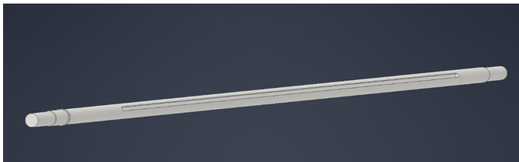
Figura 14. Diseño 3D eje de cilindrar.
