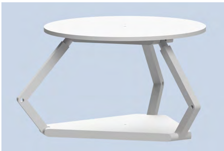
Figura 5.3: Modelo CAD simplificado de la plataforma empleado para simulación.
