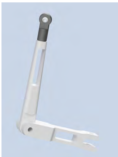
Figura 5.2: Detalle de la cadena cinemática RRS.
