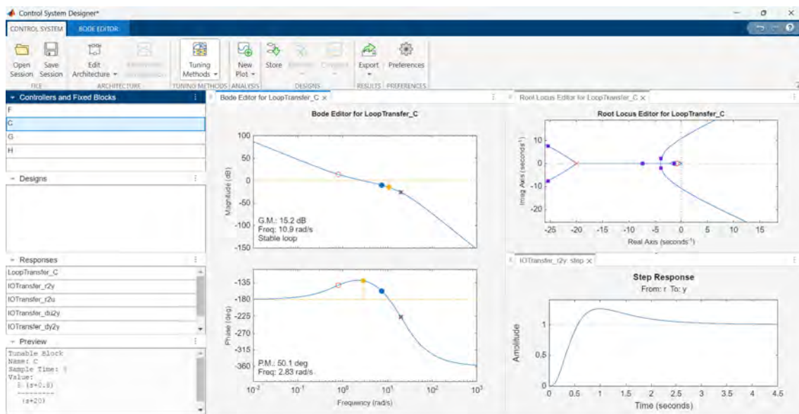
Figura 8.7: Configuración del controlador mediante Control System Designer.
