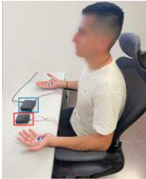
Figura 5.7: Disposición experimental durante la adquisición de las señales de EDA. Se indica en color azul el dispositivo con excitación en AC, mientras que el sistema con excitación en DC se señala en color rojo (J. D. Romero-Ante; Montenegro-Bravo; Vicente-Samper et al., 2025).
