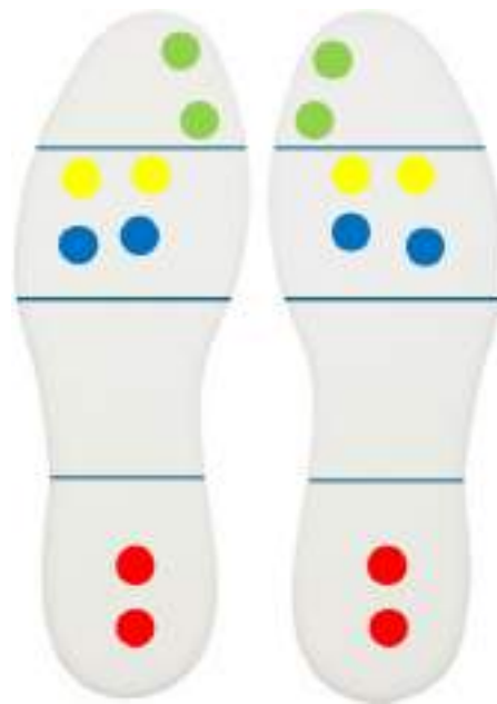
Figura 6.8: Distribución de los electrodos en la plantilla para la medición de EDA. Se muestran las ubicaciones definidas para cubrir las zonas críticas identificadas en el análisis dinámico de presión plantar, incluyendo las regiones de las falanges, metatarsal y talón (Figura elaborada por el autor).
