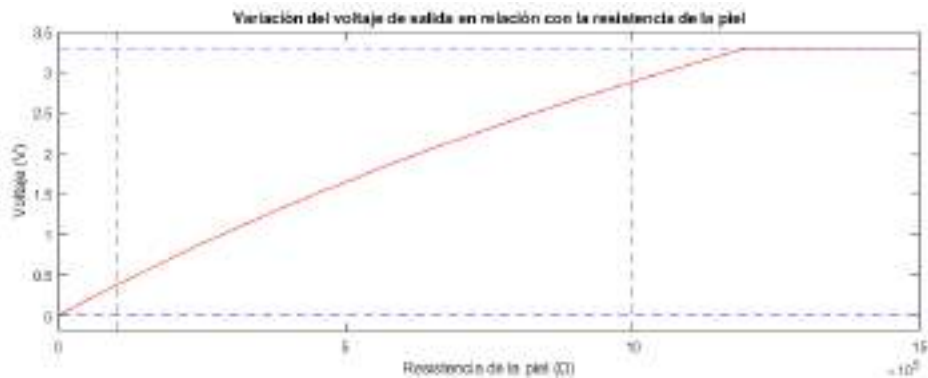
Figura 4.2: Resultado de la simulación del circuito de medición de EDA. Se aprecia la variación del voltaje de salida en función de la resistencia de la piel. Las líneas horizontales punteadas en azul indican los límites de saturación del amplificador operacional. Las líneas verticales punteadas en negro delimitan el rango de medición (J. D. Romero-Ante; Vicente-Samper; Manrique-Cordoba et al., 2024b).
