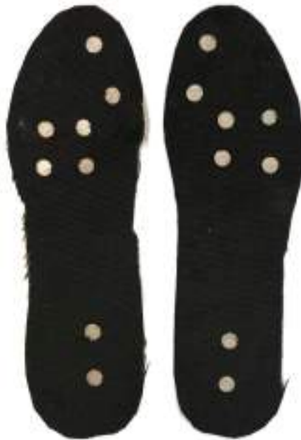
Figura 6.12: Resultado final de la plantilla de silicona con los electrodos integrados y el recubrimiento de tela (Figura elaborada por el autor).
