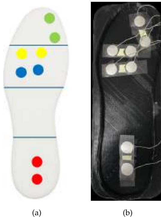
Figura 6.11: a) Distribución conceptual propuesta para la ubicación de los electrodos sobre la plantilla (Figura elaborada por el autor).
