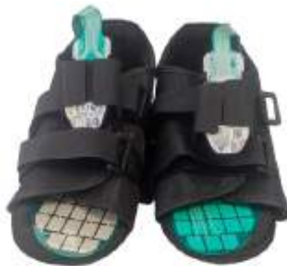
Figura 6.4: Integración del calzado ortopédico Orliman CP01 con la plantilla del sistema F-Scan64 utilizada para el registro experimental de la presión plantar (Figura elaborada por el autor).
