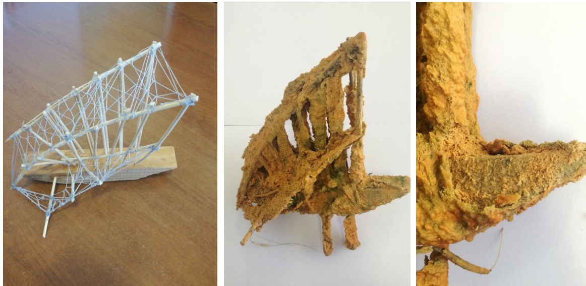
Fig. 16. Petrificación sobre preforma de madera e hilo. María Isabel Sánchez Bonilla (2023). Los desprendimientos de la roca que se va formando sobre la madera resultan evidentes.
