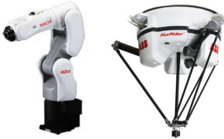
Figura 2. Ejemplo de robot tipo serie (izquierda) vs robot tipo paralelo (derecha).
