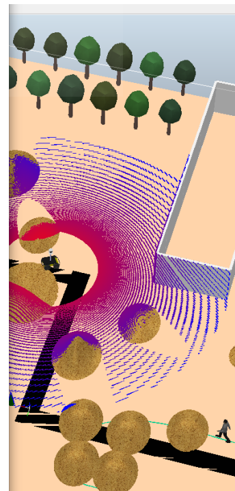
Figura 53. Ejecución del sistema sin trayectoria válida durante la planificación en el entorno 3.
