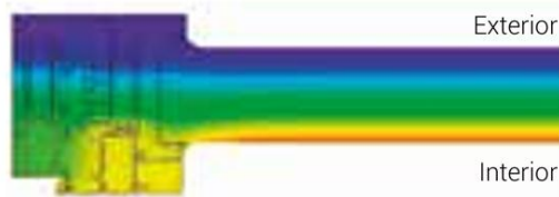
Figura 10. Perfil térmico del marco.
