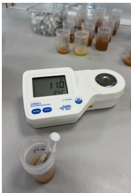
Figura 8. Medición de SST en zumo de nectarina con refractómetro digital.
