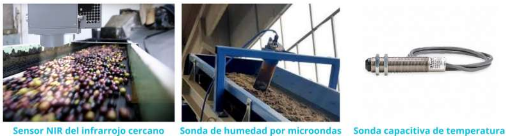
Figura 3.3: Sensores colocados en la cinta de castigo
