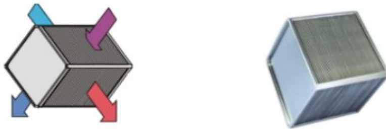
Figura 115. Intercambiador aire-aire de placas de flujo cruzado
