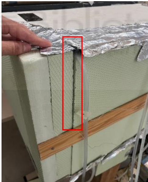
Figura 119. Filtraciones de aire en las paredes del equipo
