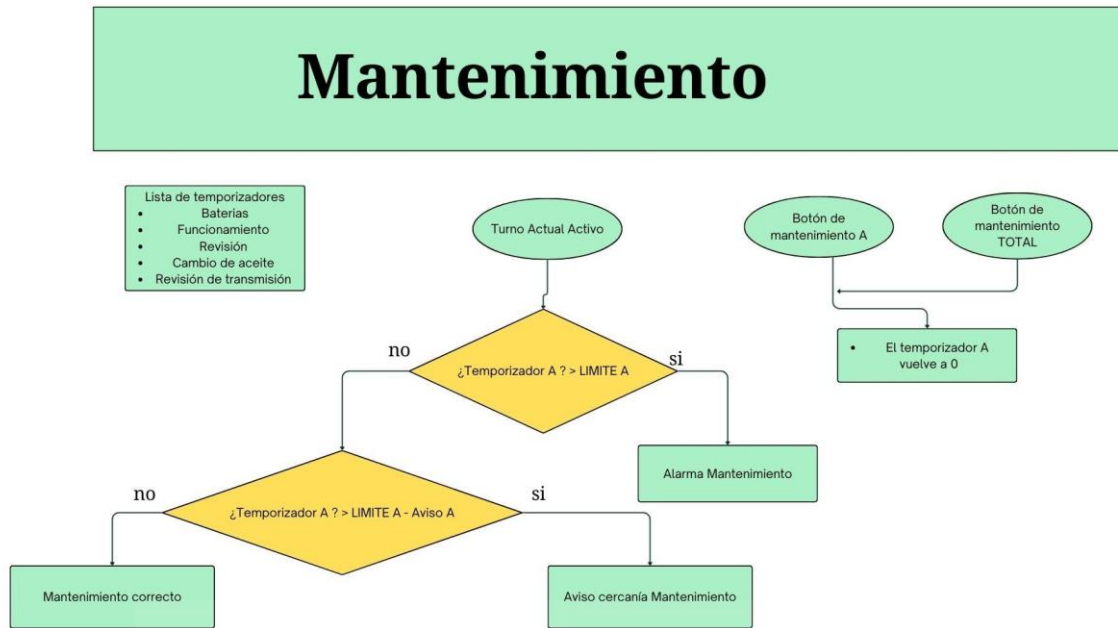
Figura 28. Diagrama de flujo de la lógica de control para el módulo de mantenimiento preventivo.
