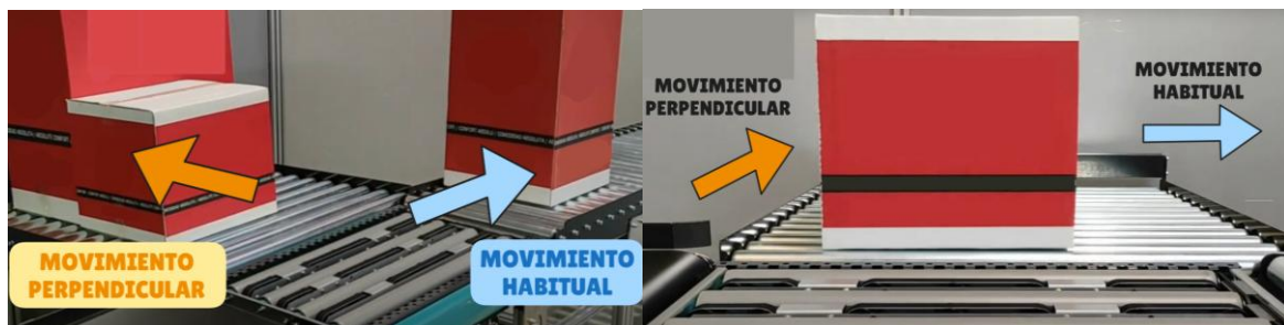
Ilustración 1.9 – Funcionamiento del transfer de correas en situación 2
