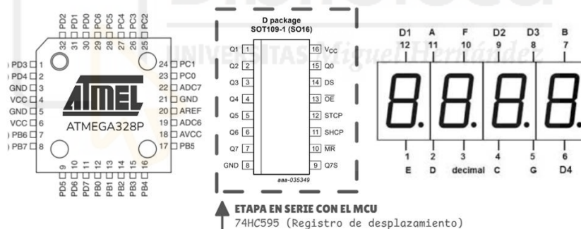
Ilustración 3.9 – Arquitectura de control del display mediante registro de desplazamiento 74HC595
