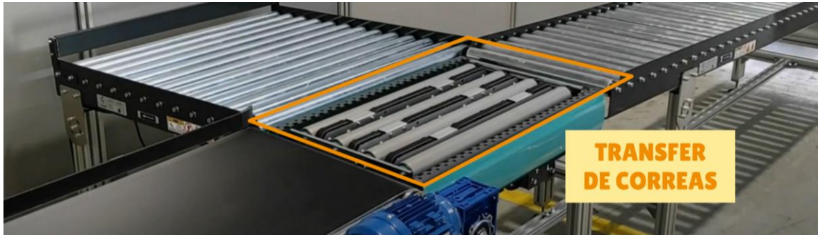
Ilustración 1.7 - Identificación del transfer de correas en instalación real
