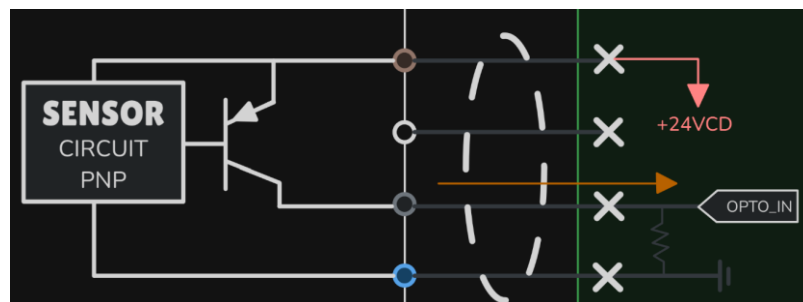
Ilustración 3.14 – Lógica PNP y asignación de pines del conector M12
