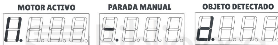
Ilustración 5.2 - Representación de estados del sistema en el display de 7 segmentos
