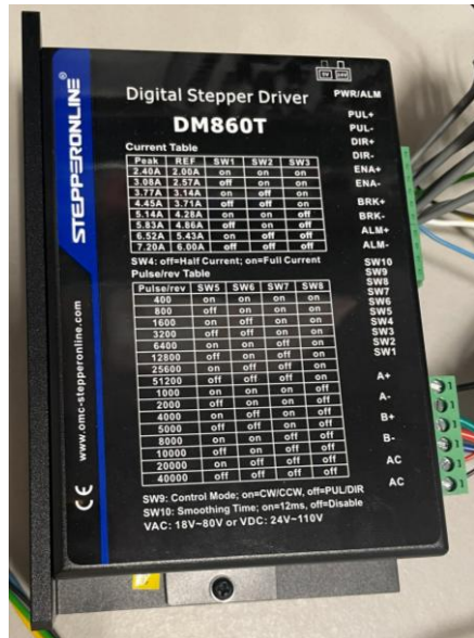
Ilustración 2.1 – Driver digital DM860T: vista real y esquema técnico del dispositivo
