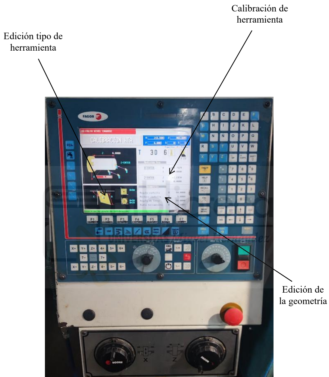
Ilustración 22: Pantalla para la calibración de herramientas.
