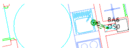
Ilustración 47: Red de pequeña evacuación del fregadero de la habitación 4
