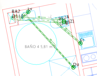
Ilustración 48: Red de pequeña evacuación del baño de la habitación 4 y el fregadero de la 5
