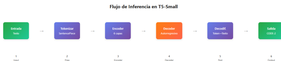
Figura 2.2: Flujo de inferencia en T5-Small. El encoder procesa la entrada y el decoder genera tokens de salida secuencialmente.
