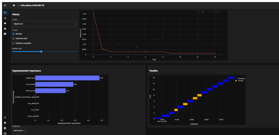
Figura 3.15: Ejemplo de base de datos generada durante la optimización automática de hiperparámetros con Optuna.
