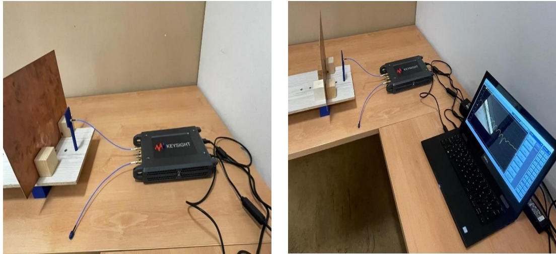
Figura 21: VNA conectado a la antena frente la plancha metálica.
