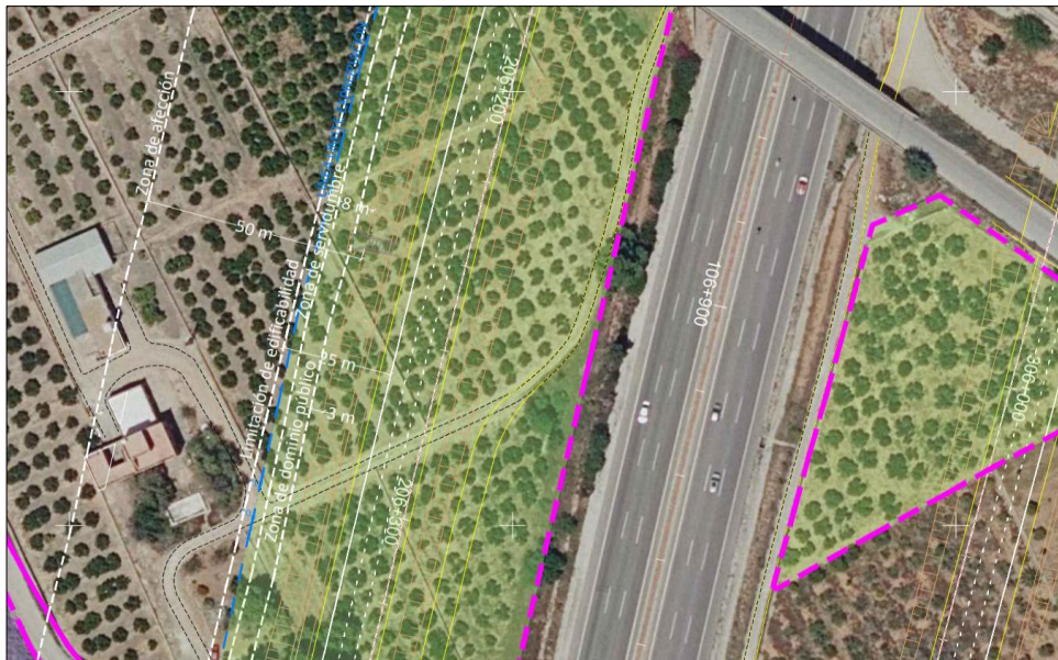
Figura 3. Zonas de protección de carreteras. Fuente: elaboración propia a partir del Proyecto de Trazado.
