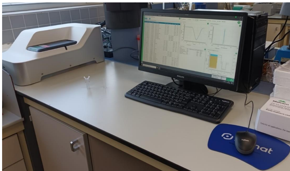
Figura 8. A la izquierda Zetasizer Advance Ultra Red (Malvern Panalytical Ltd., Malvern, Worcestershire, United Kingdom), en el centro monitor para visualización de datos, y a la derecha cubetas para medir tamaño de partícula (DTS0012) y potencial Z (DTS1070).
