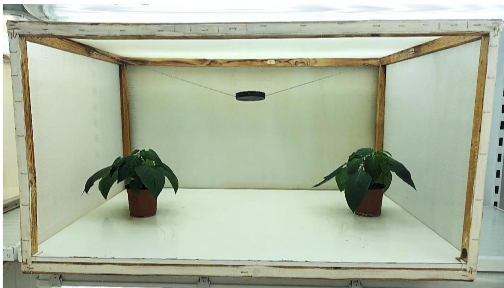
Figura 16. Jaula entomológica de 100 × 55 × 70 cm utilizada en el bioensayo de elección (planta control y planta tratada) y placa Petri negra como plataforma de vuelo de los pulgones alados.
