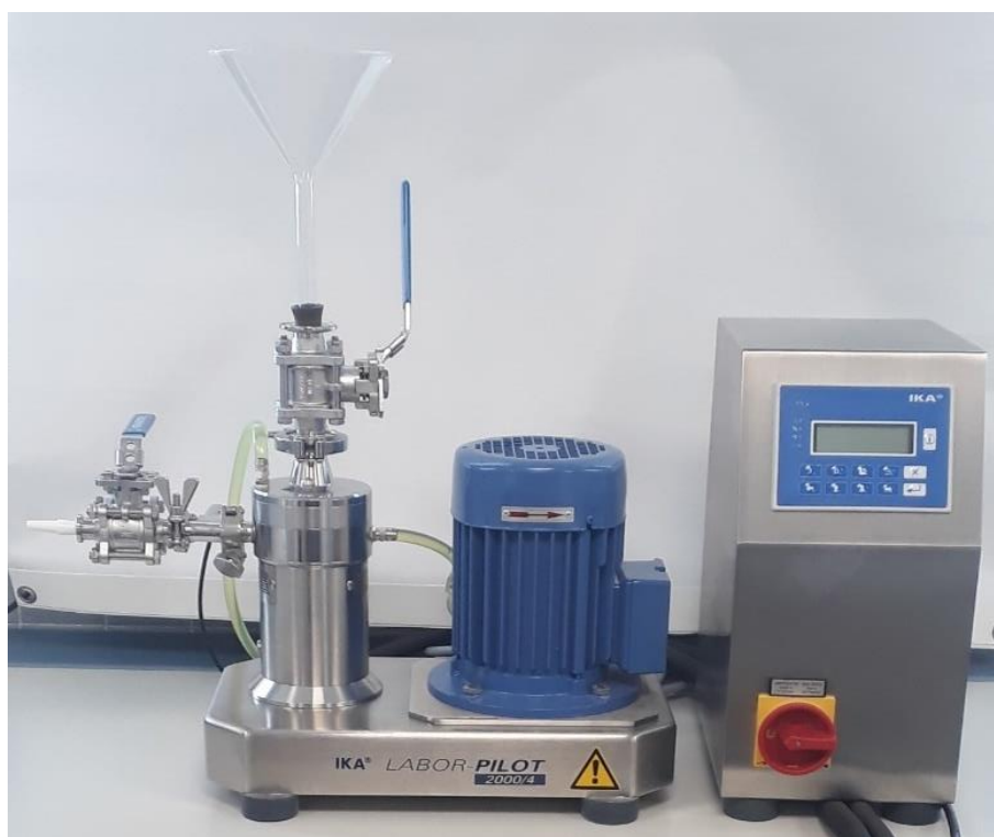
Figura 6. Homogeneizador de alta velocidad IKA Labor Pilot Controller 2000/4 (IKA-Werke GmbH and Co. Staufen, Germany).
