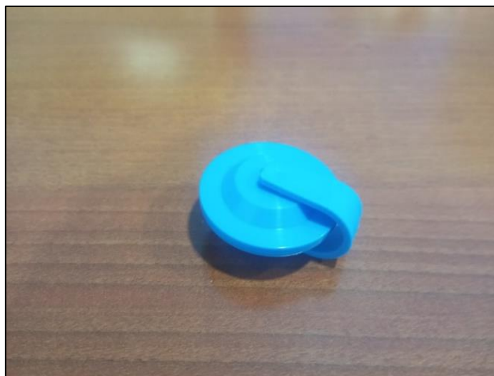
Figura 19. Filtro de membrana de P.V.C. prepesado de 37 mm de diámetro y 0,5 \mu m de poro. Fotografía tomada por Christian Sánchez García.
