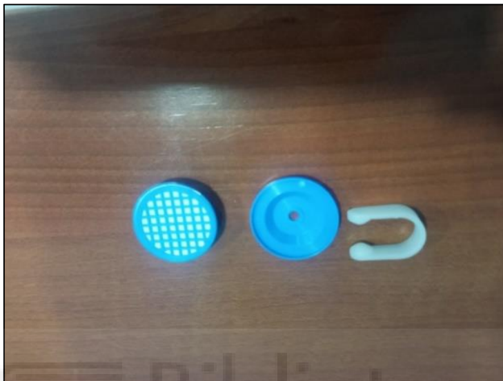
Figura 22. Filtro de membrana de P.V.C. prepesado de 37 mm de diámetro y 0,5 \mu\text{m} de poro. Retirada del tapón de protección. Fotografía tomada por Christian Sánchez García.
