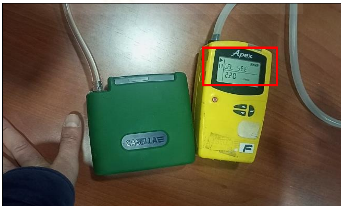
Figura 16. Calibración del caudal de medición, establecido en 2,2 litros/minuto. Fotografía tomada por Christian Sánchez García.
