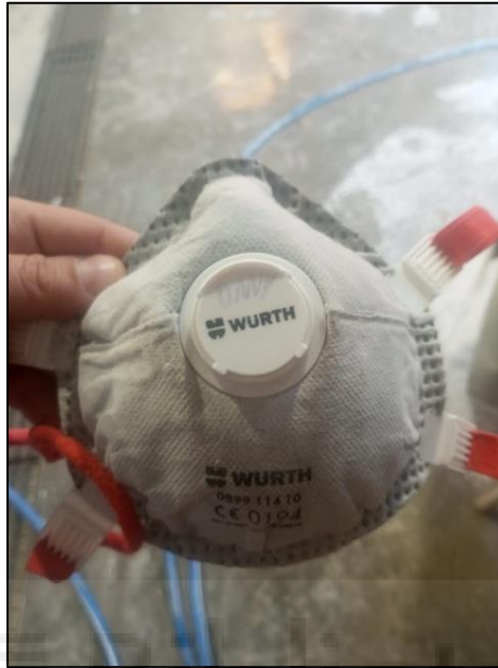
Figura 15. Mascarilla autofiltrante Wurth Cat. III. UNE-EN 149:2001 + AC:2009, FFP3, con marcado CE. Fotografía tomada por Christian Sánchez García.
