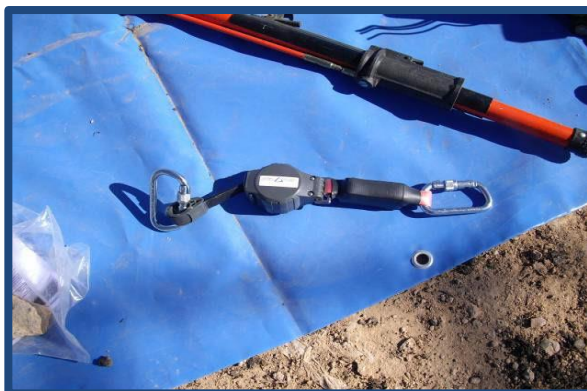
Figuras 29 y 30 Sistema anticaídas retráctil
