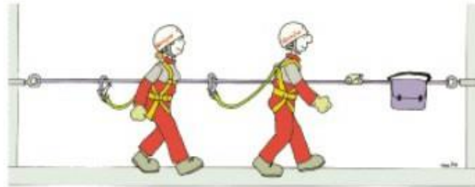
Figura 9 Ejemplo de línea de vida de cinta
