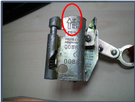
Figuras 10 y 11 Ejemplos flecha del sistema anticaídas tipo “rana”
