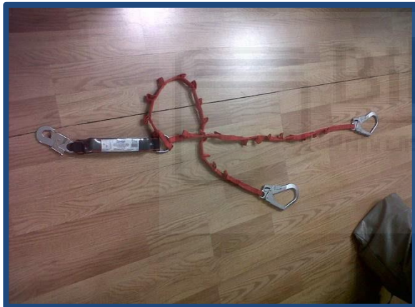
Figuras 27 y 28 Doble gancho de cinta y doble gancho con cuerda
