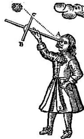
Ilustración sobre el uso de la ballestilla. En: John Sellers, Navegación Práctica , 1672
