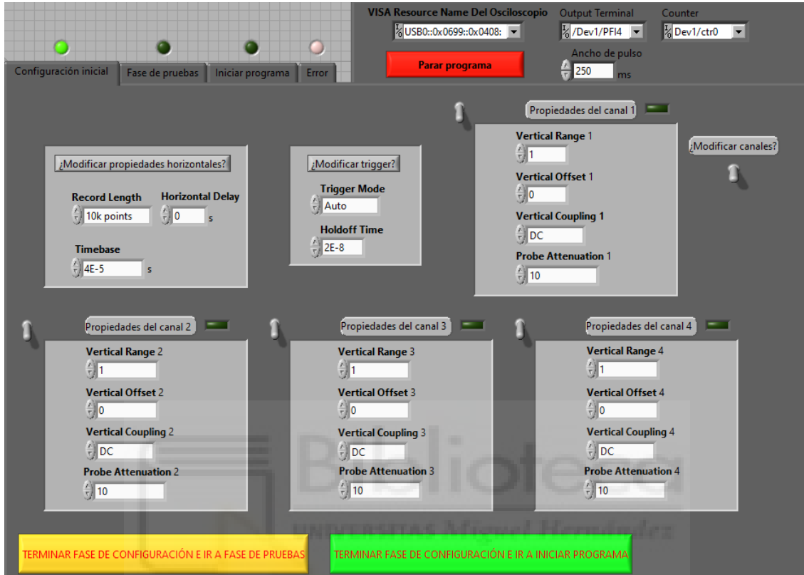
Fig. 15: Ventana de configuración inicial del programa de control del banco de trabajo en LabVIEW.
