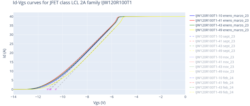
Fig. 63: Curvas de I_d - V_{gs} de JFET de referencia IJW120R100T1 en las fechas de enero/marzo junto con sus rectas de extrapolación lineal y la intersección de estas con el eje de abscisas.
