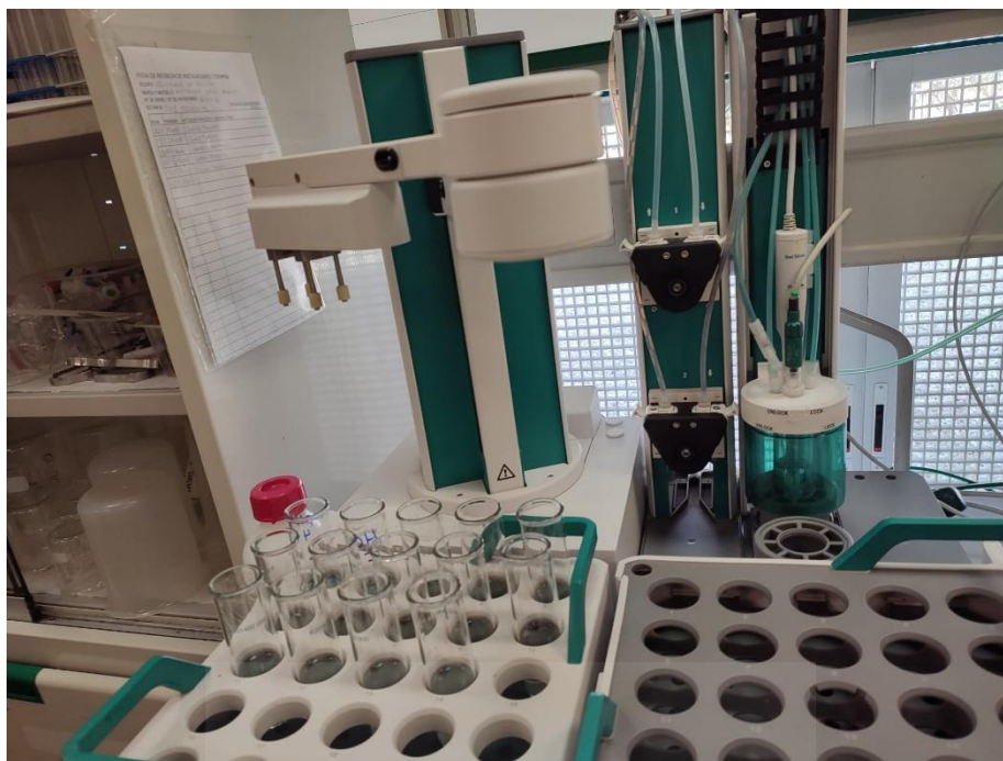
Fotografía 10: Valorador automático Methrom, utilizado para determinar la acidez.
