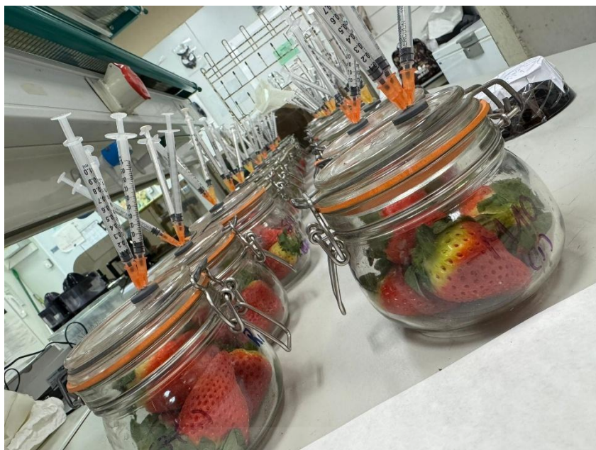
Fotografía 4: Sistema estático propuesto por Kader
