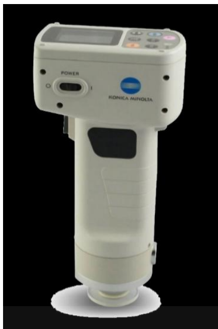
Fotografía 8: Colorímetro utilizado para medir el color de las fresas.
