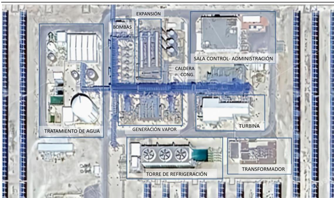
Figura 13. Plano de los subsistemas principales de la planta Enerstar-Villena
