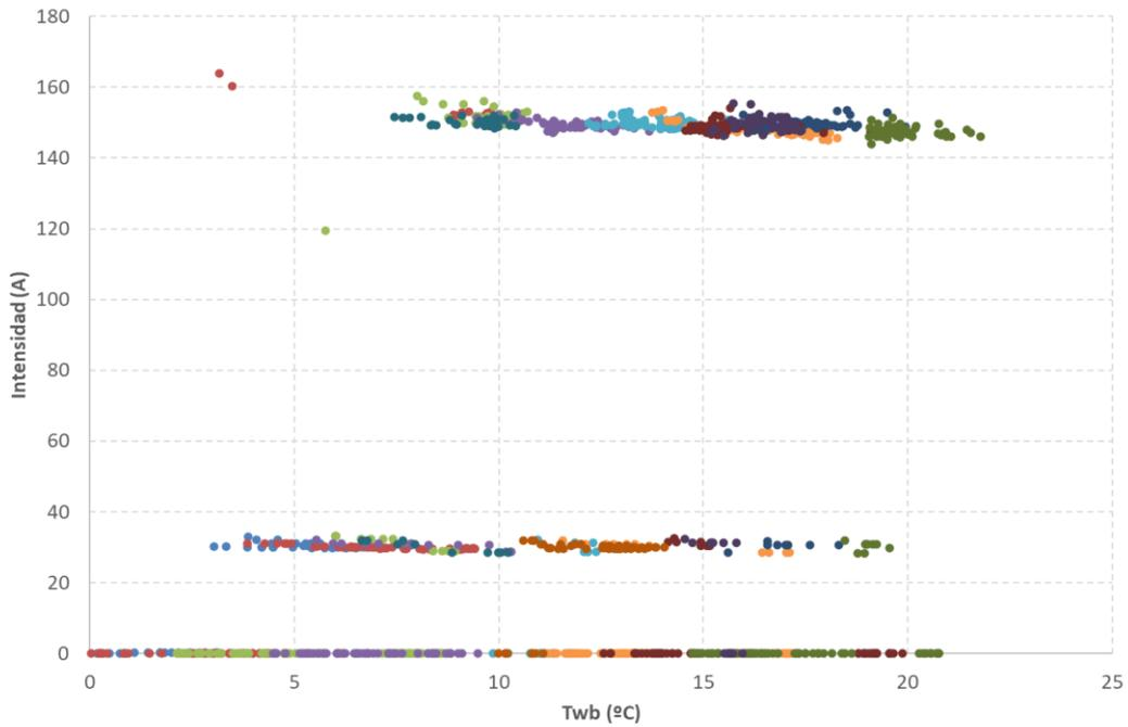
Figura 67. Ventilador 3 (Control: 2 velocidades)
