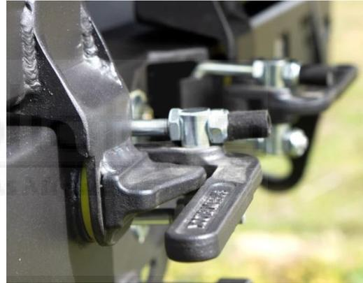
Ilustración 48: Vista detalle cierre de soportes.
