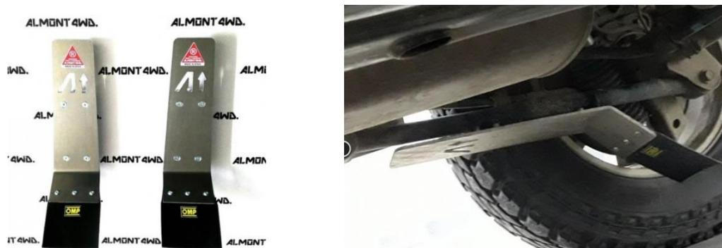
Ilustración 60: Planchas de protección de amortiguadores traseros
