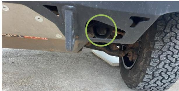
Detalles del dispositivo de remolque original que queda al descubierto
