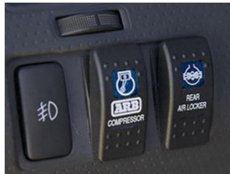
Ilustración 32: Compresor y mando de funcionamiento.
