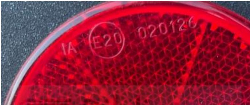
Ilustración 53: Dispositivo de alumbrado catadióptrico trasero no triangular.
