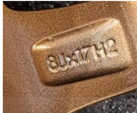
Ilustración 34: Desplazamiento de la llanta y ancho.
