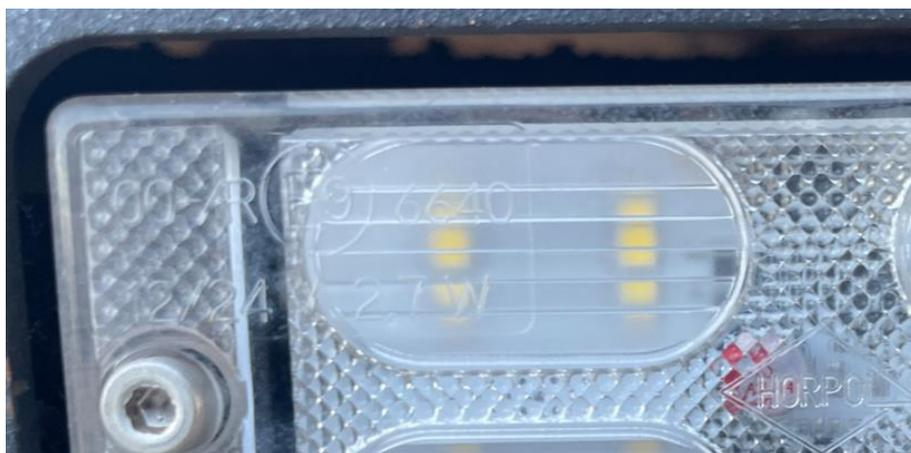
Ilustración 51: Dispositivo de alumbrado de marcha atrás.
