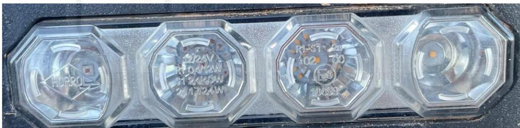
Ilustración 54: Dispositivo de alumbrado intermitencia, posición y freno tarsero.
