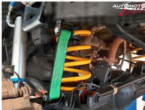
Ilustración 14: Limitadores de extensión. Fuente: Automotor 4x4
