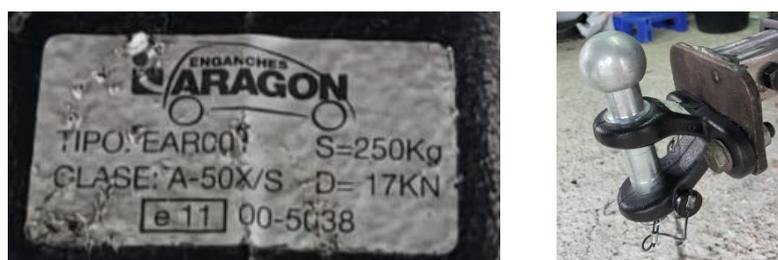
Ilustración 67: Huevo para dispositivo de acoplamiento.
