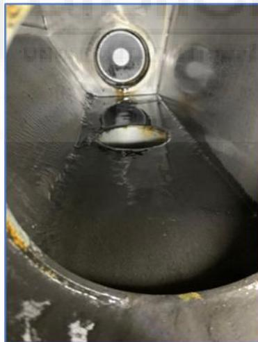
**Figura 19** - Partículas decantadas en el depósito inferior
