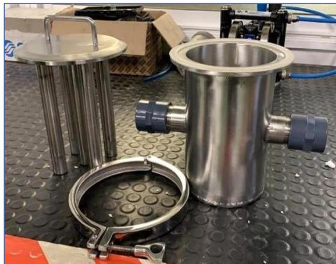
Figura 12 - Filtro magnético y componentes
