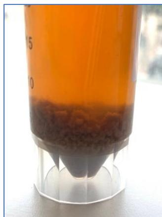
Figura 13 - Muestra extraída del proceso de filtración con materia floculada
