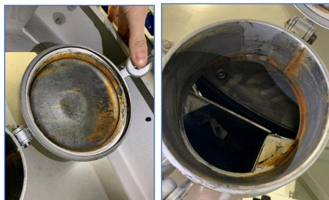
Figura 21 - Tapas de fundición oxidadas
