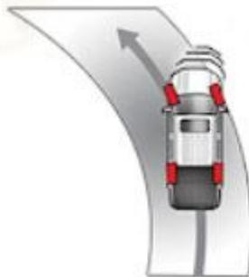
Ilustración 64 Esquema subviraje. Fuente: extraída de una página web <http://aguaxcrawl-4x4.blogspot.com>
