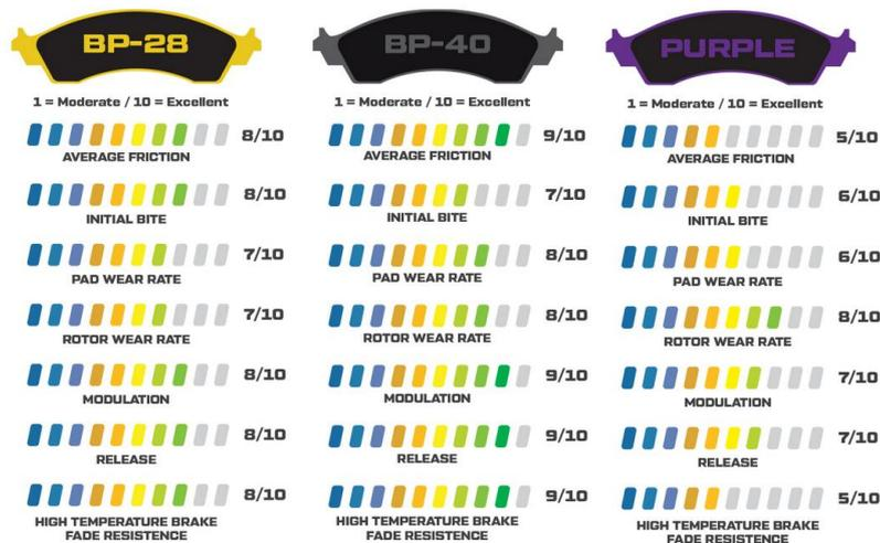
Ilustración 42 Comparación de los 3 tipos de pastillas seleccionados. Fuente: extraída de una página web <https://www.wilwood.com>
