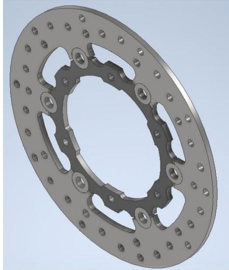
Ilustración 73 Disco de freno delantero
