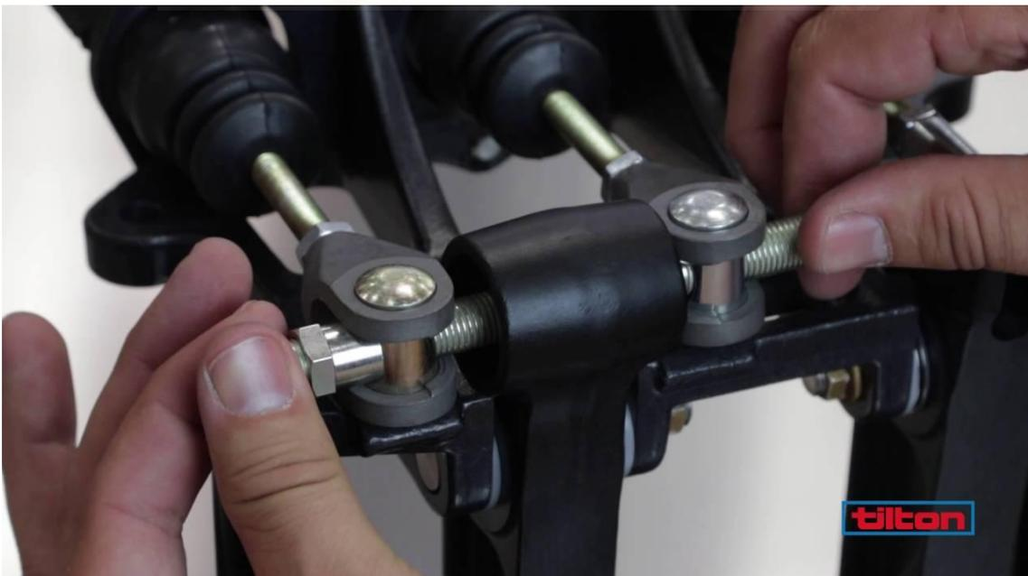
Ilustración 34 Ajuste repartidor de frenada. Fuente: extraída de una página web [tiltonracing.com](http://tiltonracing.com)
