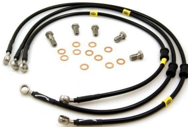
Ilustración 47 Latiguillos de freno metálicos flexibles.
