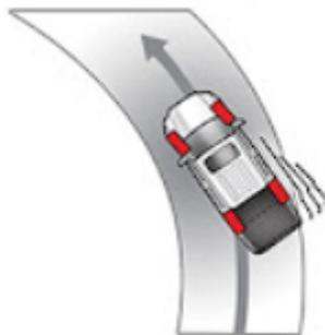
**Ilustración 62** Esquema sobreviraje. Fuente: extraída de una página web <http://aguaxcrawl-4x4.blogspot.com>
