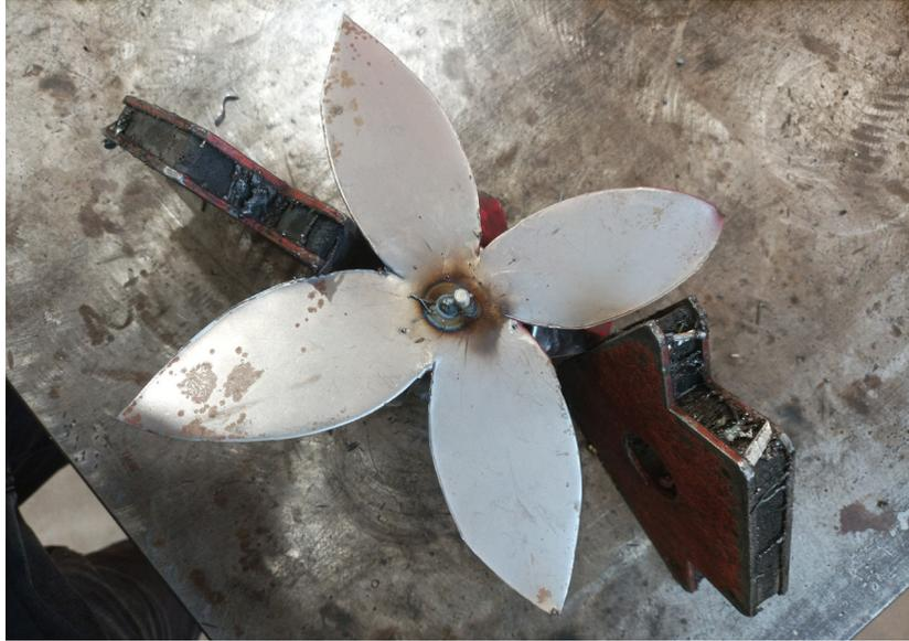
Fig 7: Foto de la soldadura que hune los pétalos.
