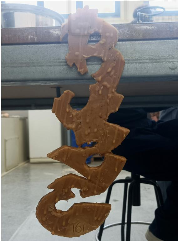
Fig. 11: La pieza de cera a partir de la que se hace el molde para la pieza de bronce
