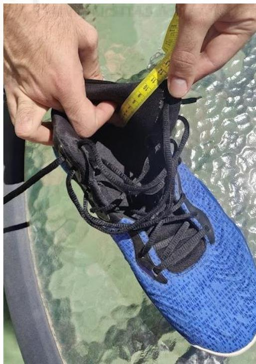
*Imagen 3. Medición de la altura del collarín con cinta métrica. Elaboración Propia.*
