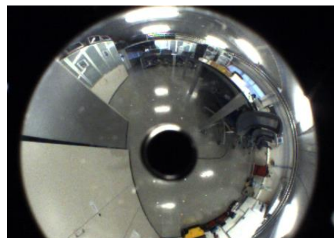
Figura 2- 1. Sistema catadióptico omnidireccional e imagen que genera (sacada de la base de datos Omni DB dataset 2 – Laboratory Trajectory disponible en [58]).
