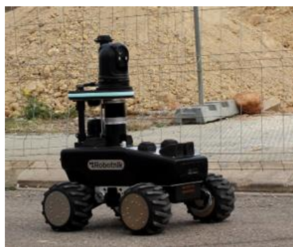
Figura 1- 4. Robot RB-WATCHER diseñado por Robotnik destinado a tareas de vigilancia autónoma. (Imagen sacada de [113])
