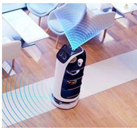
Figura 1- 2. Robot Bellabot diseñado por Pudu Robotics para entrega de alimentos. (Imagen sacada de [111])
