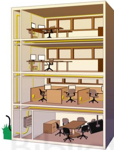
Ilustración 11. Cableado estructurado en el interior de un edificio, Fuente: <https://www.redestelecom.es/>.
