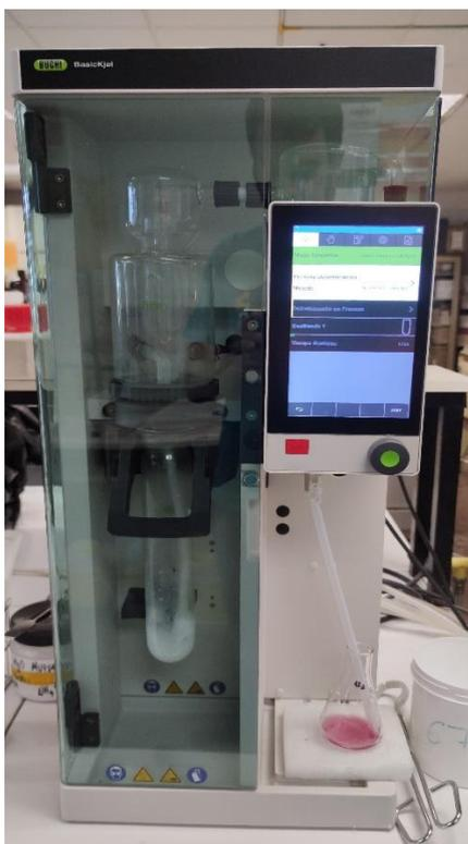
Figura 6: Destilador BUCHI para determinación de  $\text{NO}_3^-$  y  $\text{NH}_4^+$ .
