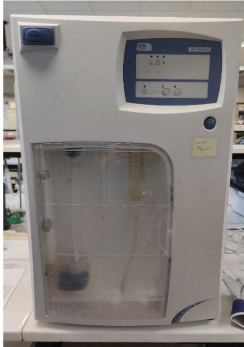
*Figura 5: Destilador Kjeldahl por arrastre de vapor para determinación de NTK.*
