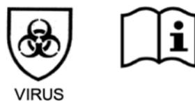
**Figura 4.** Pictograma de los guantes para EPI frente a microorganismos incluidos los virus según la normativa UNE-EN ISO 374-5:2016.
