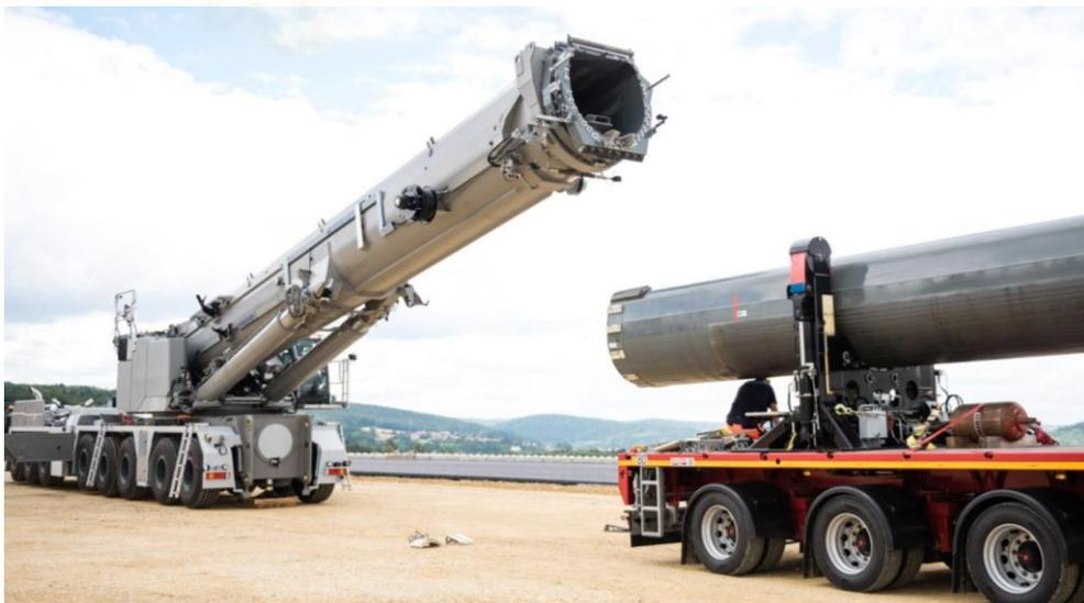
**Figura 4.8** Instalación de tramos de pluma internos en una grúa LTM 1650 8-1.
