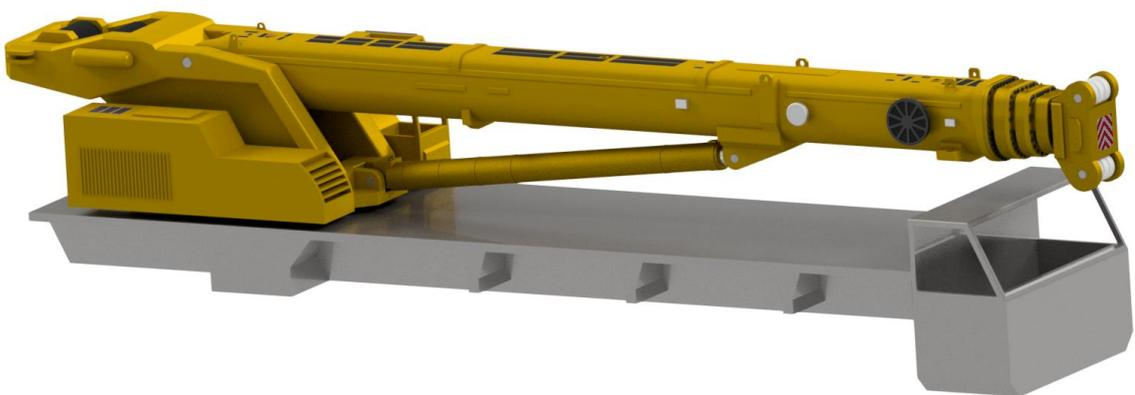
**Figura 18.1** Pluma telescópica modelada final
