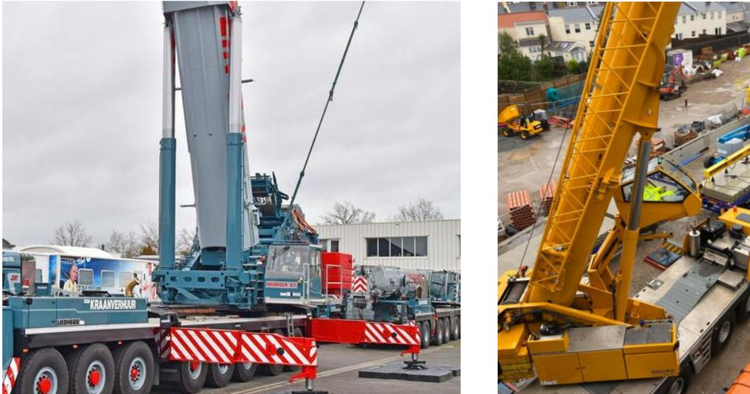
**Figura 12.2** Configuración de cilindro doble y único en una grúa móvil
