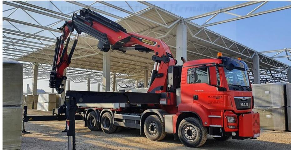
**Figura 4.1** Grúa Palfinger PK 165.002 TEC 7 montada sobre camión.
