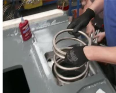
Figura 7.13 Muelles empleados y su colocación real
