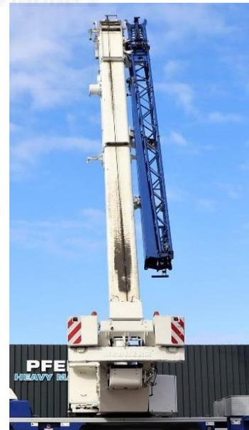
**Figura 11.1** Plumín lateral doble abatible de una LTM 1050
