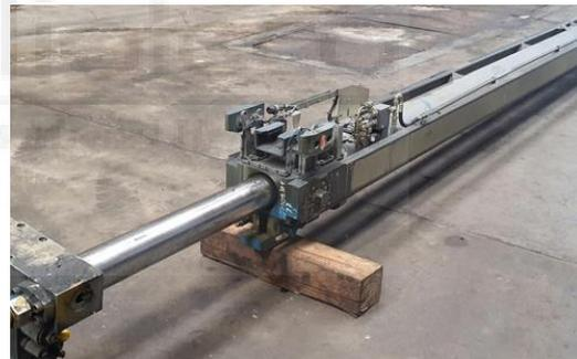
**Figura 12.3** Cilindro interno de telescopado
