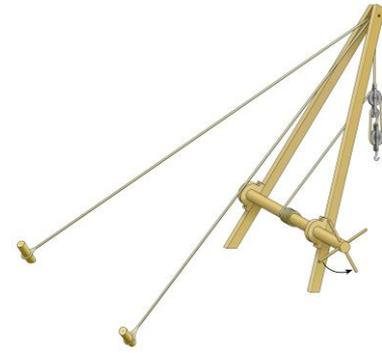
**Figura 1.1** Ejemplo de una grúa griega
