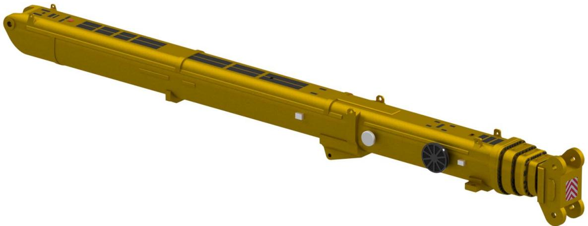
**Figura 7.16** Pluma modelada completamente ensamblada
