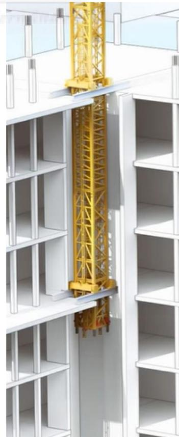
**Figura 1.8** Grúa torre autotrepante
