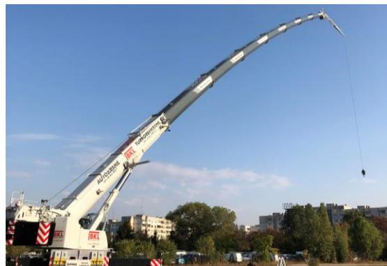
**Figura 9.5** Plumitas telescópicas deformadas
