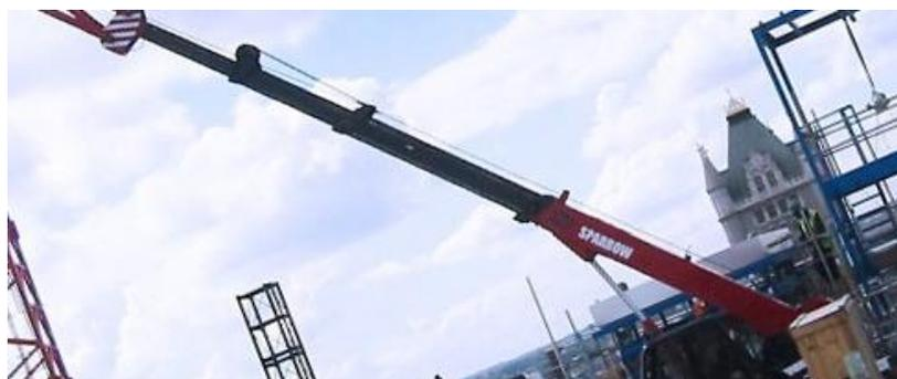
**Figura 4.3** Grúa con pluma telescópica basada en poleas
