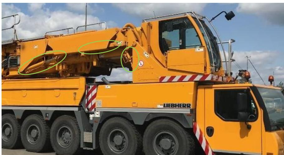
**Figura 12.7** Cilindros en el brazo de la cabina móvil
