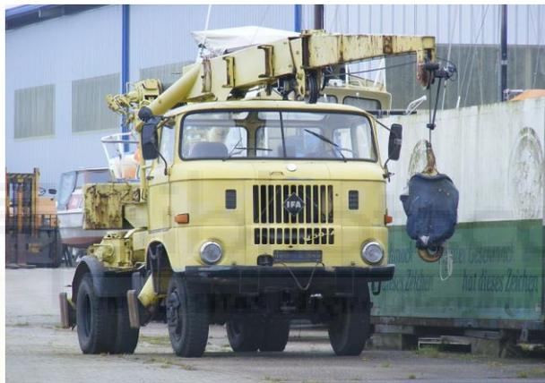
**Figura 1.4** Grúa móvil autopropulsada de la década de los 70.
