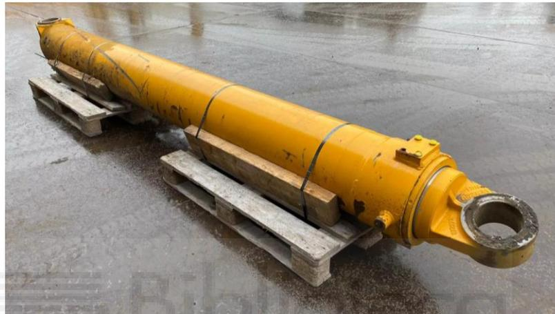
Figura 13.5 Cilindro hidráulico de una grúa LTM como el proyectado
