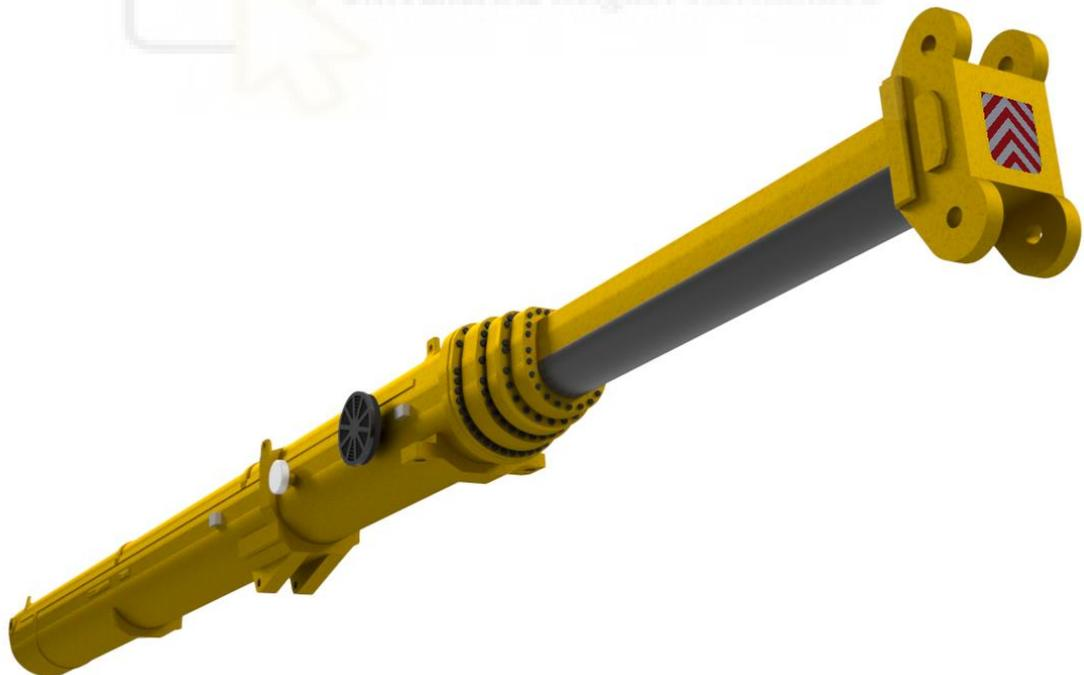
Figura 7.20 Ensamblaje de la pluma con el último tramo desplegado
