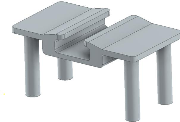
**Figura 7.11** Pinza de anclaje pin superior
