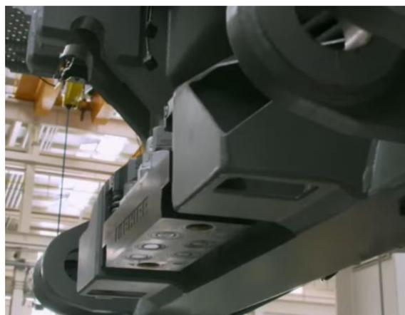
**Figura 17.6** Acople rápido de líneas hidráulicas
