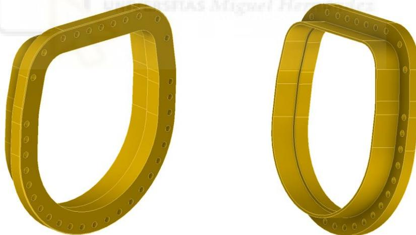
Protegen el interior de la pluma, además de servir como elemento de unión con otras piezas, como por ejemplo las pastillas de deslizamiento. A su vez, aportan rigidez a la pluma, mejorando la resistencia estructural.
