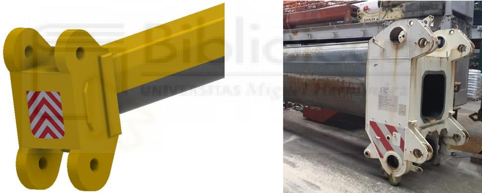
**Figura 7.3** Cabeza de la pluma del tramo 5 y una real
