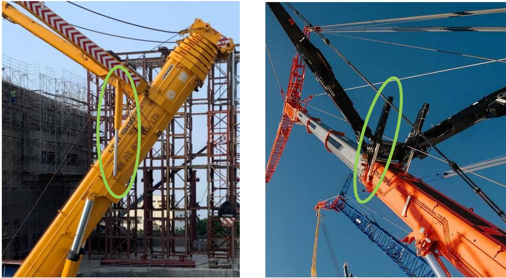
**Figura 12.4** Cilindros auxiliares para accesorios de la pluma
