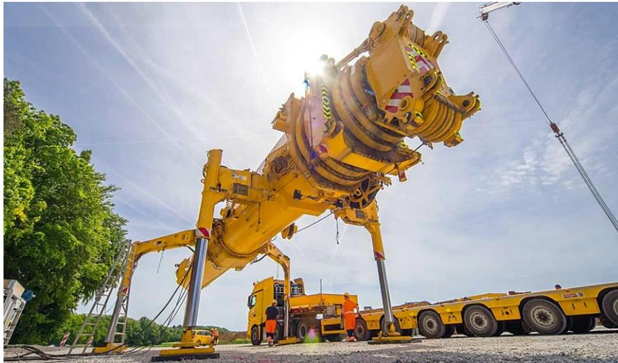
**Figura 12.5** Cilindros soporte para una pluma pesada
