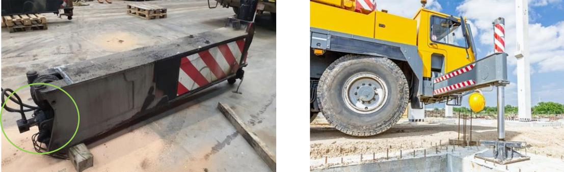
**Figura 12.6** Cilindros en los estabilizadores laterales de una grúa móvil (horizontales y verticales).
