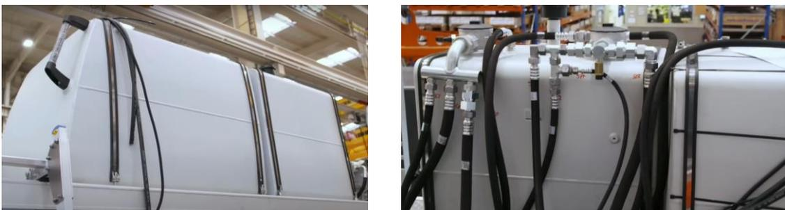
**Figura 17.5** Depósitos de fluido hidráulico en una grúa móvil
