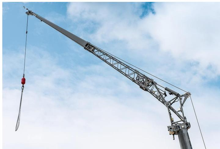
Figura 11.3 Plumín abatible doble con ajuste hidráulico
