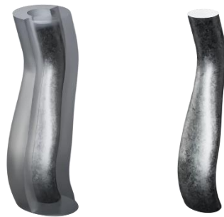
Ilustración 77 - Colada de la aleación LM95 para obtener mandril metálico
