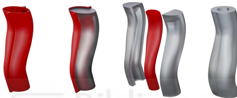
Ilustración 76 - Fabricación del molde de silicona de las conducciones
