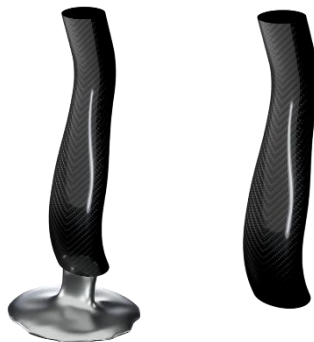
Ilustración 79 - Fusión del mandril para obtener conducción final
