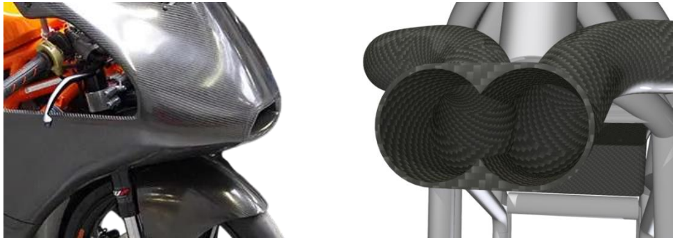
Ilustración 53 - Detalle de la toma de aire
