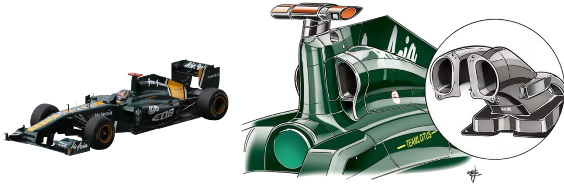
Ilustración 17 - Ram-air intake del Lotus T128 [5]
