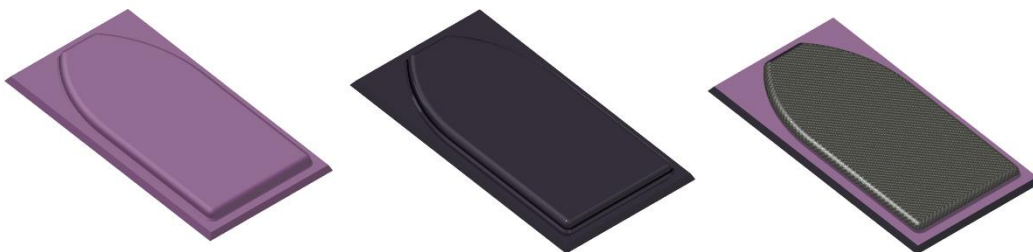
Ilustración 86 - Impresión 3D del patrón, postprocesado de éste y laminación de fibra de carbono
