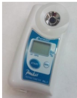
Figura 26. Refractómetro utilizado para medir el contenido de sólidos solubles.
