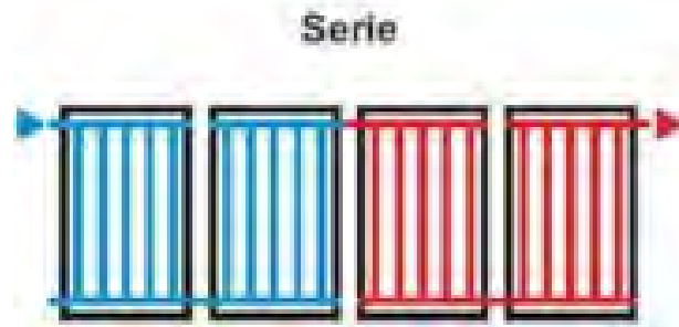
Figura 13. Representación de captadores solares conectados en serie
