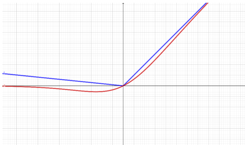
Figura 57. Diferencias entre SiLU (rojo) y LeakyReLU con pendiente negativa (azul).
