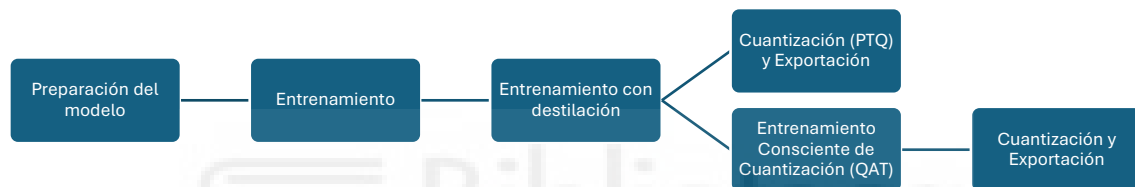
Figura 55. Infografía de las etapas para la obtención de YOLOv6m.
