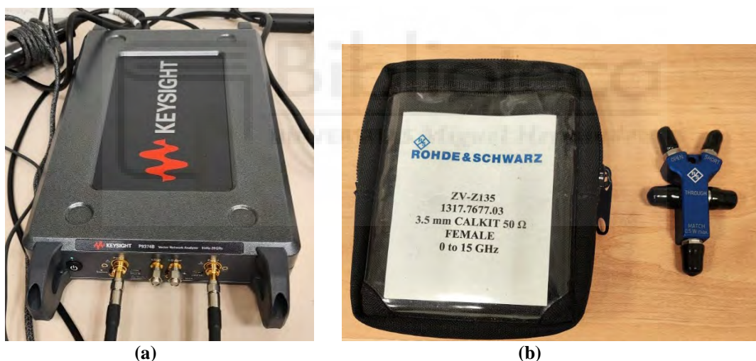
Figura 19. (a) VNA Keysight P9371B. (b) Kit de calibración ZV-Z135 (3.5 mm, 50 ohmios, 0 a 15 GHz)
