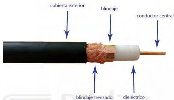
Figura 8. Estructura de cable coaxial
