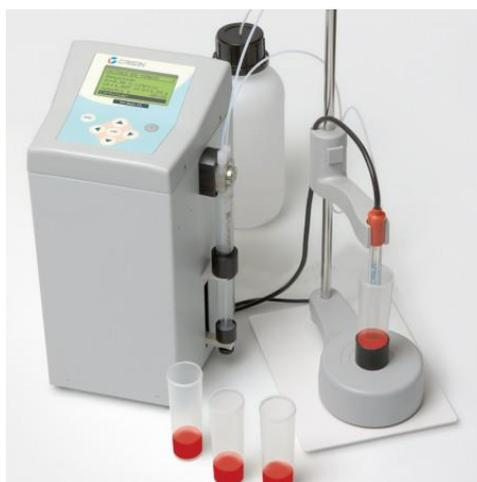
**Ilustración 11. Proceso de valoración de la acidez (Fuente: Crison Instruments).**
