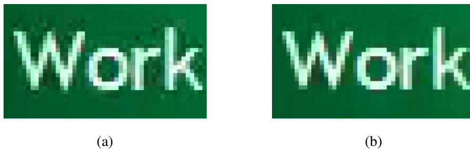
Figura 2.16: Ejemplo de aplicación de filtro SAO: (a) filtro SAO desactivado, (b) filtro SAO activado [62]
