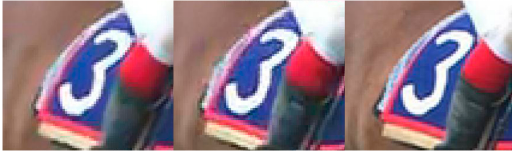
Figura 3.3: Ejemplo de aplicación del filtro SAO para una región aumentada de un frame de la secuencia RaceHorses, codificado con QP=32: (izquierda) SAO habilitado, (centro) SAO deshabilitado, (derecha) Imagen original [62].
