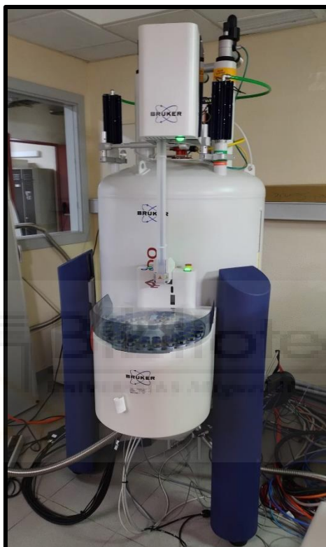
Figura 4. Ascend NMR Magnet 500 MHz con el que se realizó ^1\text{H} NMR.
