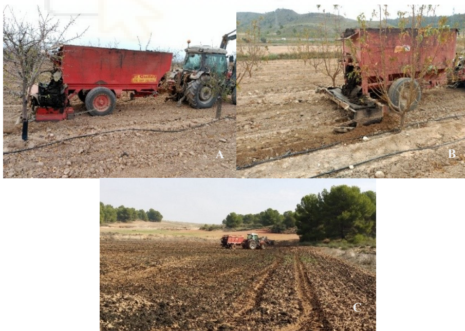
Figura 17. Sistema de aplicación de lodo en el suelo agrícola. A: aplicación mediante topo o surco en cultivo de almendro, B: aplicación mediante topo o surco en cultivo de nectarina, C: aplicación mediante esparcido en cultivo de cereal.
